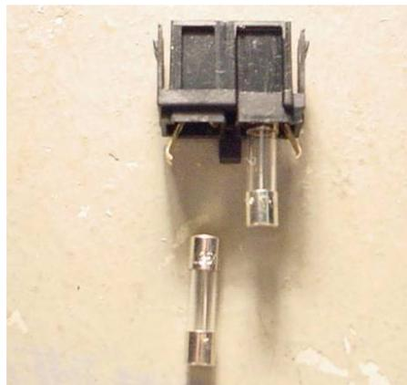
5. Retire a gaveta do fusível. Com a gaveta retirada, você conseguirá remover os fusíveis de vidro para inspeção. Veja se o filamento interno está queimado. Se os fusíveis estiverem danificados, substitua os fusíveis pelos fusíveis adequados, conforme descrito na etiqueta do número de série. (Localizada acima da gaveta do fusível e interruptor de força da rede elétrica).
