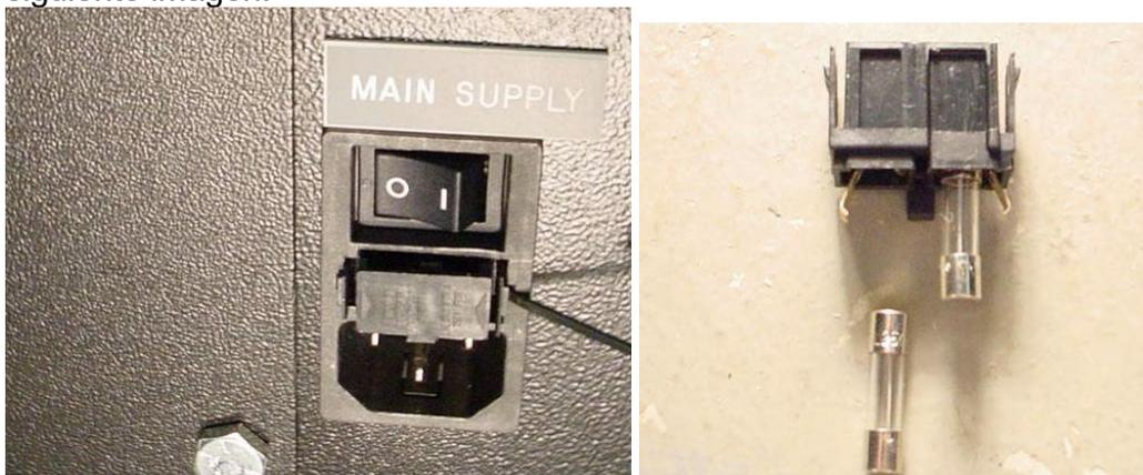
5. Retire la caja de fusibles. Una vez retirada, puede sacar de ésta los fusibles de vidrio para su inspección. Compruebe si el filamento interno se ha quemado. Si los fusibles están dañados, reemplácelos como se describe en la etiqueta del número de serie (localizada encima de la caja de fusibles y el interruptor de alimentación principal).
