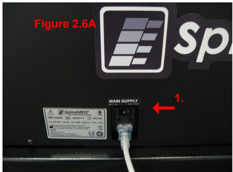
apagar el interruptor principal (# 1-Figura 2.6A) antes de desconectar el aparato de la toma de corriente para evitar el fundido de los fusibles.
