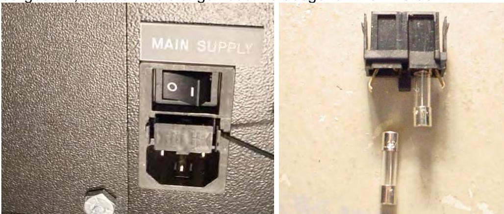
5. Den Sicherungshaltereinschub entfernen. Nachdem der Sicherungshaltereinschub herausgenommen wurde, können die Glassicherungen aus dem Einschub genommen und begutachtet werden. Überprüfen, ob der interne Glühfaden durchgebrannt ist. Falls die Sicherungen beschädigt sind, müssen diese durch entsprechende neue Sicherungen, wie auf dem Seriennummernschild (oberhalb von Sicherungshalterungseinschub und Netzschalter) beschrieben, ersetzt werden.
