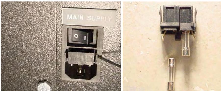
5. Retirez le tiroir à fusibles. Une fois que vous avez retiré le tiroir, vous serez en mesure de sortir les fusibles en verre du tiroir afin de les inspecter. Vérifiez si le filament interne est brûlé. Si les fusibles sont endommagés, remplacez-les par des fusibles adéquats correspondants au numéro de série sur l'étiquette. (Située au-dessus du tiroir à fusibles principal et de l'interrupteur d'alimentation).
