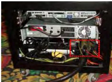
C) Die runden Amphenol-Anschlüsse sind nicht untereinander austauschbar, da es sich einmal um einen dreipoligen und einmal um einen vierpoligen Anschluss handelt. Bei dem dritten Kabelanschluss handelt es sich um einen neunpoligen Standardserienstecker. Schrauben Sie zur Entfernung des Kabels die beiden Steckerschrauben mit Hilfe eines kleinen Schraubenziehers auf. Um den neuen Serienstecker zu befestigen, schrauben Sie die beiden Sicherungsschrauben mit einem kleinen Schraubenzieher wieder zu.
