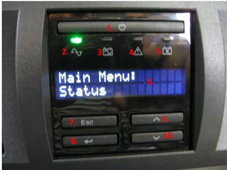
B) Auf der vorderen Abdeckung des USV-Moduls (Notstromversorgung) in der Steuerkonsole befinden sich 4 LED-Systemanzeigen, sowie ein digitales Display (Auswahlmenü), welche dem Anwender sowohl den Systemstatus als auch etwaige Systemfehler anzeigen. Folgende Funktionen beschreiben den System Status:
