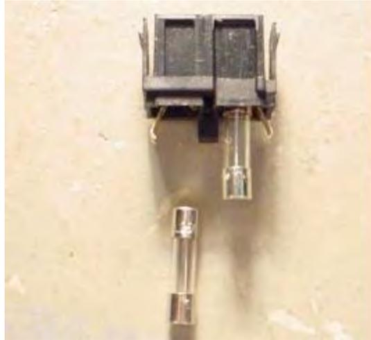
6. Der Sicherungseinschub muss beim Wiedereinsetzen eine spezielle Position aufweisen. Auf einer Seite des Einschubs befindet sich in der Mitte eine kleine Öse; diese muss beim Wiedereinsetzen des Einschubs in das Modul nach unten zeigen.
