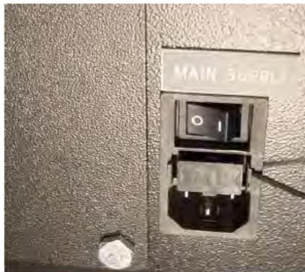
5. Entnehmen Sie den Sicherungseinschub. Jetzt können Sie die Glassicherungen zur Begutachtung aus dem Einschub herausziehen und überprüfen, ob der Glühfaden durchgebrannt ist. Tauschen Sie beschädigte Sicherungen durch Sicherungen derselben Seriennummer (siehe Aufschrift) aus.
