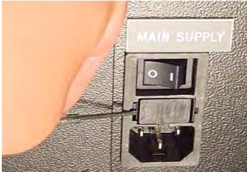
3. Der Sicherungseinschub ist vorne mit Hilfe zweier kleiner Klemmen an beiden Seiten befestigt. Lösen Sie zur Entfernung des Einschubs mit Hilfe des kleinen Schraubenziehers die Klemme erst an der einen, dann an der anderen Seite.
